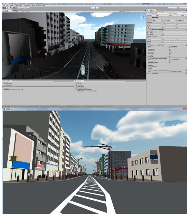
図3 ゲームエンジンを用いた景観シミュレータ
