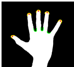
図4 輪郭ピクセルに基づく指先検出
