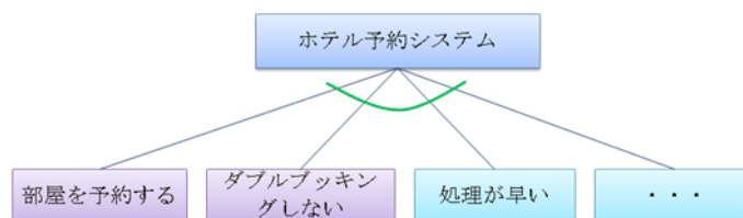
図1. ゴール指向を用いて表現した「ホテル予約システム」のAND/OR木
