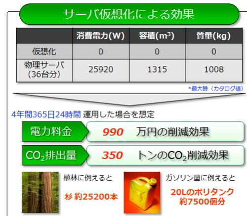
また、サーバにはブレードサーバ (PRIMERGY BX920 S1) と仮想化ソリューションを構築・導入し、物理サーバの台数を削減するとともに、大幅な省電力・省スペースを実現した (ただし、一部の基幹系サーバにはラックマウント型のサーバ (PRIMERGY RX300 S5 等) を利用した)。富士通の試算によると、このことにより、従来のサーバ構成 (PRIMERGY RX200 S3 及び PRIMERGY TX200 S3) に比べ全体の約 25% に当たる 36 台のサーバを削減でき、4 年間 365 日 24 時間運用した場合、最大で電力料金として約 990 万円、CO<sub>2</sub> 排出量としては約 350 トンの削減効果がある (表 2 参照)。
