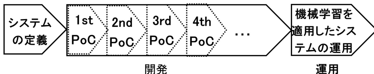
図 1 一般的な機械学習を適用したシステム開発と運用のプロセス
