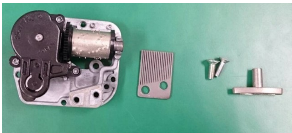
図3 実験用オルゴールの部品
